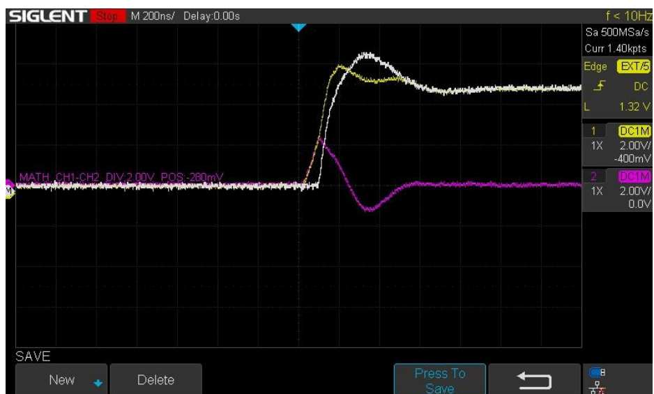
Rysunek 5 Pomiar napięcia na końcu skrętki
